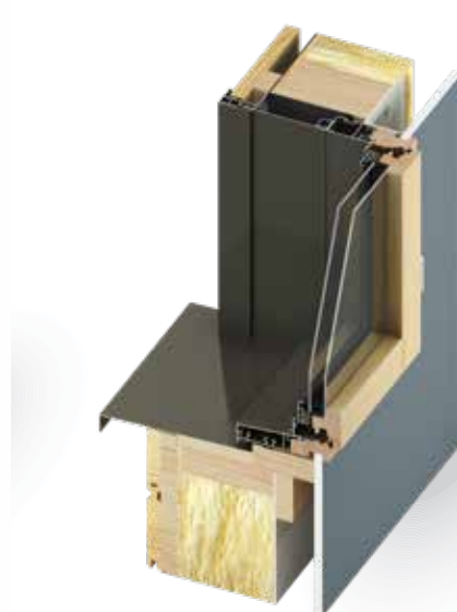
Adaptation pour mur ossature bois (HEMOB)
