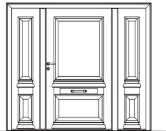
**Odyssée** avec semi-fixe (ouvrable) et fixe en faux ouvrant coordonné. H 2150 / L 2190.
